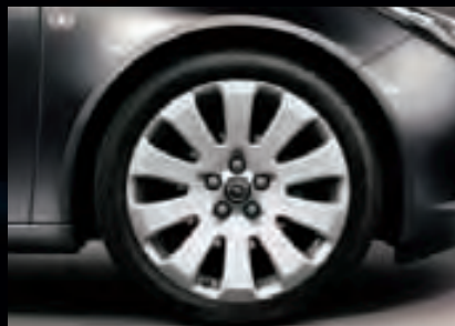
8 Легкосплавные колесные диски, 8.5 J x 19, 10-спиц, шины 245/40 R 19 (Q9S). Колесные диски с зеркальной полировкой.
