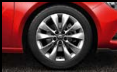
Легкосплавные колесные диски, 7,5 J x 18, многолучевой дизайн, шины 235/50 R 18 (RQJ). Входит в стандартную комплек- тацию Sport.
