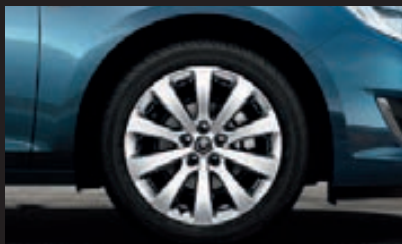
Легкосплавные колесные диски, 7 J x 17", многолучевой дизайн, шины 215 (225)/50 R 17 (PGQ). 3
