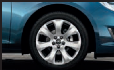
Легкосплавные колесные диски, 7 J x 17", 7-лучевой дизайн, шины 215 (225)/50 R 17 (RCN). 4
