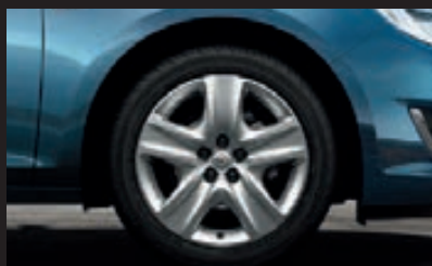
Структурные колесные диски, 7 J x 17", 5-лучевой дизайн, шины 215 (225)/50 R 17 (PWT). 2
