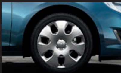
Стальные колесные диски с колпаками, 6.5 J x 16", шины 205 (215)/60 R 16 (PWM) 1 .
