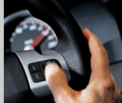
**Аудиосистема CD 30 MP3.** Стерео CD/MP3 автомагнитола с радиоприемником, 7 акустических колонок (выходная мощность 20 Вт на канал), а также клавиши управления на рулевом колесе. Дополнительный разъем для подключения аудиоустройств (диаметром 3.5 мм) расположен рядом с рычагом стояночного тормоза. Данные отображаются на трёхстрочном информационном дисплее (TID) или графическом информационном дисплее (GID), если машина оборудована устройством для мобильного телефона или климат-контролем.
