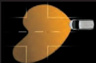
**«Город» (30–55 км/ч).** Пучок света шире и ниже, чем обычно, что позволяет лучше различать пешеходов на обочинах. Режим активируется при включенном городском уличном освещении.
