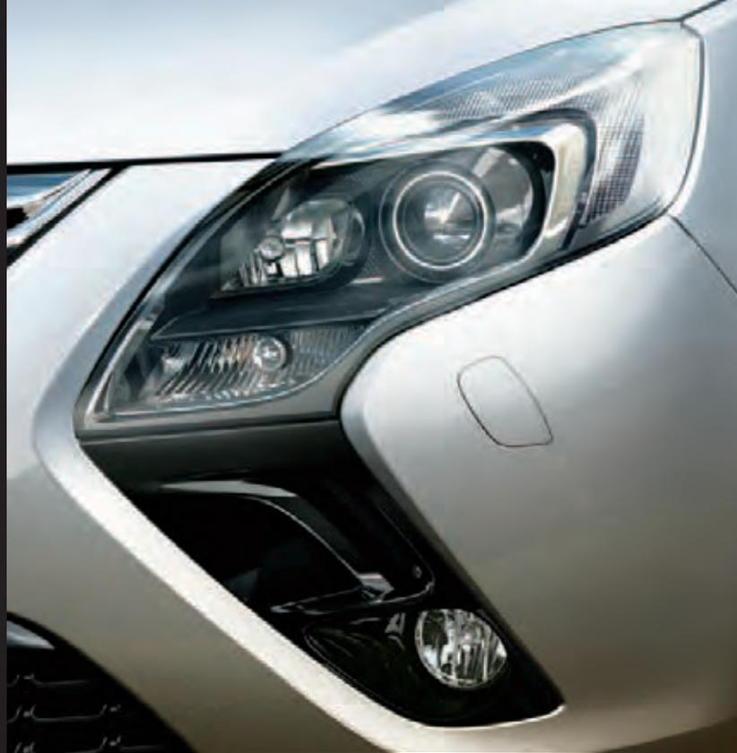
**«Дальний свет» (более 40 км/ч).** Свет фар автоматически переключается с дальнего на ближний при появлении встречного или попутно движущегося впереди автомобиля.
