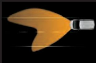
**«Проселочная дорога» (55–115 км/ч).** Пучок света шире и ярче, чем обычно. Дальность освещения достигает 70 метров. При этом, фары не слепят водителей встречных автомобилей.
