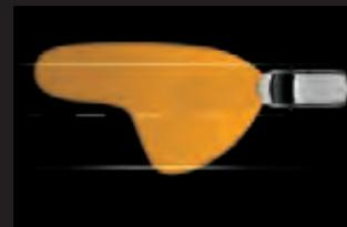
**«Дождь/Снег» (до 70 км/ч).** Данный режим включается при срабатывании стеклоочистителя или датчика дождя и применяется для повышения видимости при плохих погодных условиях.
