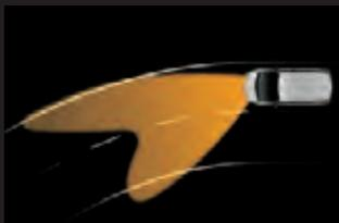
**«Поворот» (при любой скорости).** Данный режим работы фар включается на любой скорости при повороте рулевого колеса. Угол поворота фар может достигать 15 градусов.
