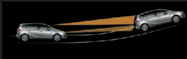
**Интеллектуальная система управления интенсивностью света (ILR).** При скорости свыше 50 км/ч система ILR увеличивает интенсивность ближнего света фар в диапазоне до 350 метров. При возникновении риска ослепления других водителей система ILR автоматически регулирует интенсивность света фар в зависимости от дорожной ситуации. На подъемах система приподнимает световые пучки фар, чтобы обеспечить водителю лучшую видимость.
