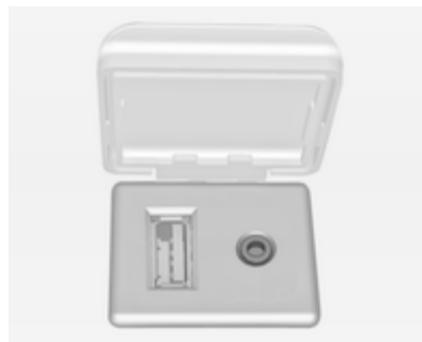
На центральной консоли имеется гнездо AUX для подключения внешних источников аудиосигналов.
