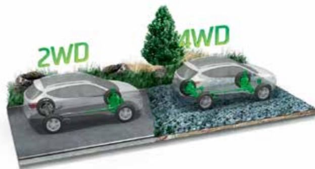
Полный привод незаменим в сложных условиях. Но при движении по хорошим дорогам использование только переднего привода экономичнее, поэтому колеса задней оси подключаются автоматически при необходимости.
