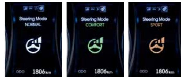
Функция Flex Steer позволяет настраивать усилие на руле по вашему желанию. Режим Normal подойдет для ежедневных поездок, Comfort — для спокойного движения с малой скоростью, Sport обеспечит острую реакцию для прохождения скоростных поворотов.
