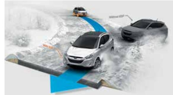
Система стабилизации применяет тормоза и ограничивает разгон при риске потерять сцепление с дорогой.
