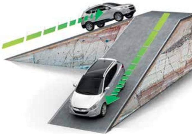
Система помощи старта в гору тормозит колеса, предотвращая скатывание назад при старте в гору.
